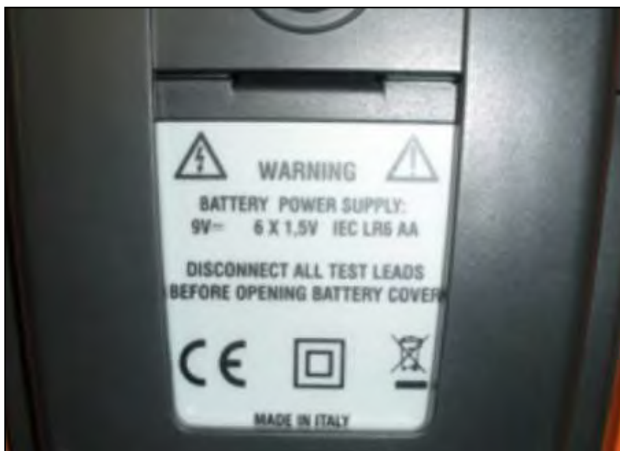
Figura 6-6 - esempio etichetta con simbolo doppio isolamento (contrassegno del "doppio quadrato") [4]
