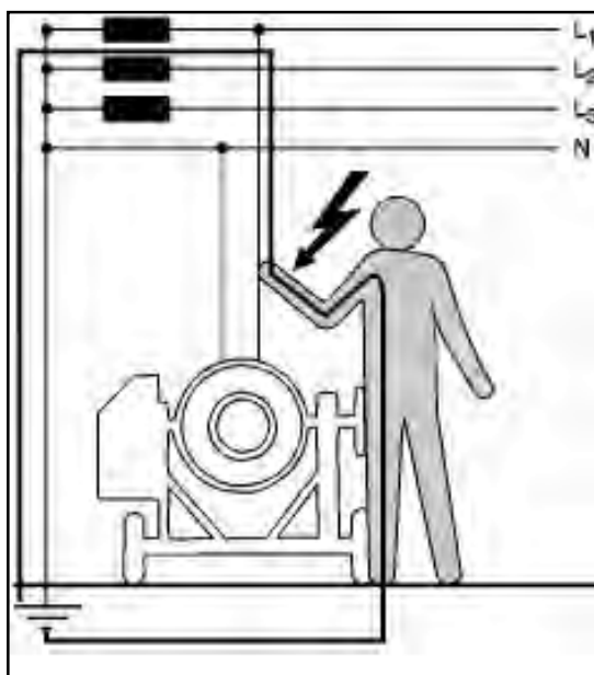
Figura 6-1 - esempio di contatto diretto [13]
