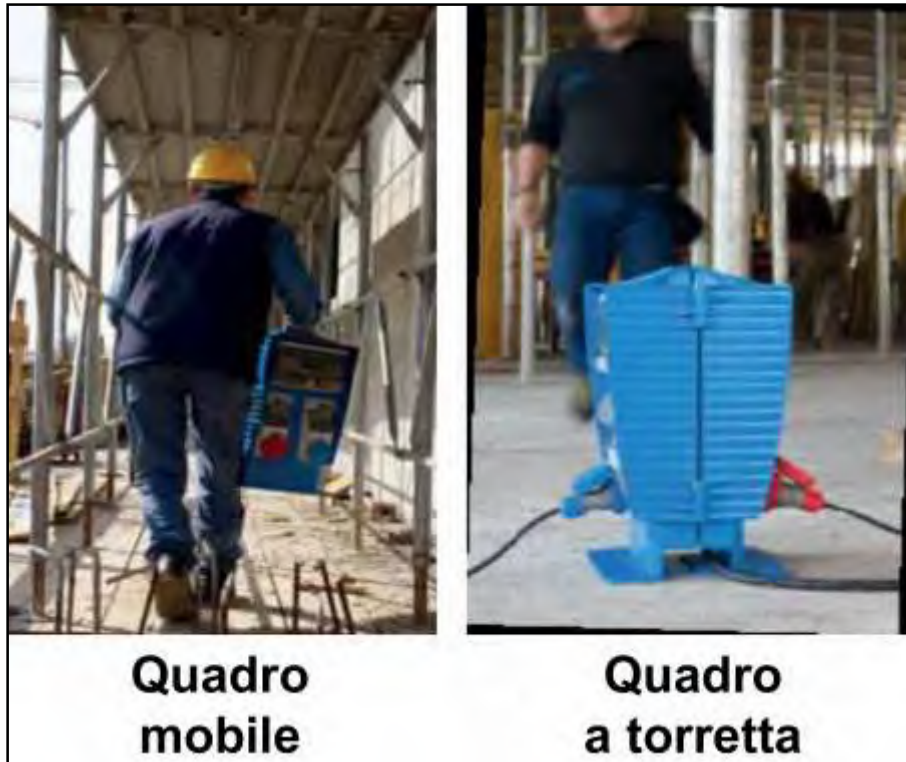
Figura 12-1 - esempi di quadri di cantiere [6]
